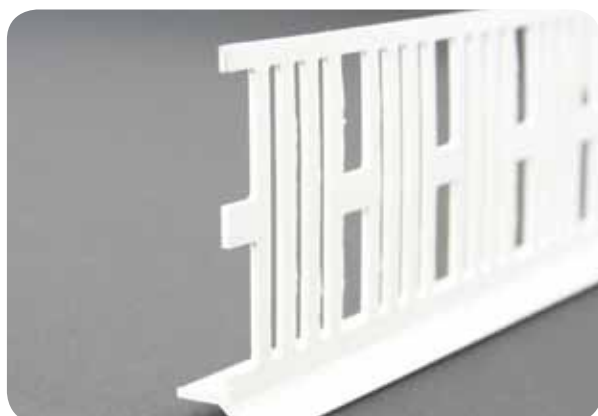
Therm 401 Afslutningsliste Afslutningsliste af hvid plast, der monteres som drypkant nederst på pladerne og går ind under pladerne som fugtbeskyttelse. Længde 2,5 m. Skrues eller klæbes fast.
